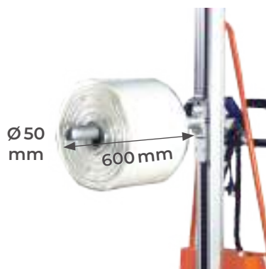
E/AXE • Axe bobine
